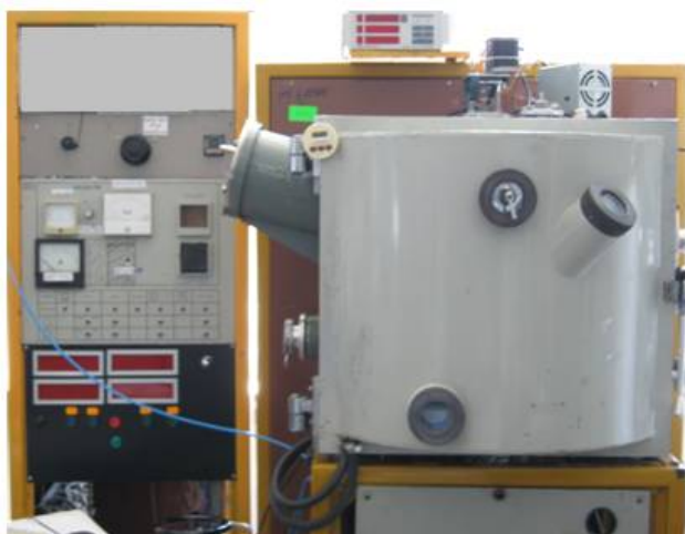
Figura 3-2 Instalația folosită pentru sinteza de filme DLC.
